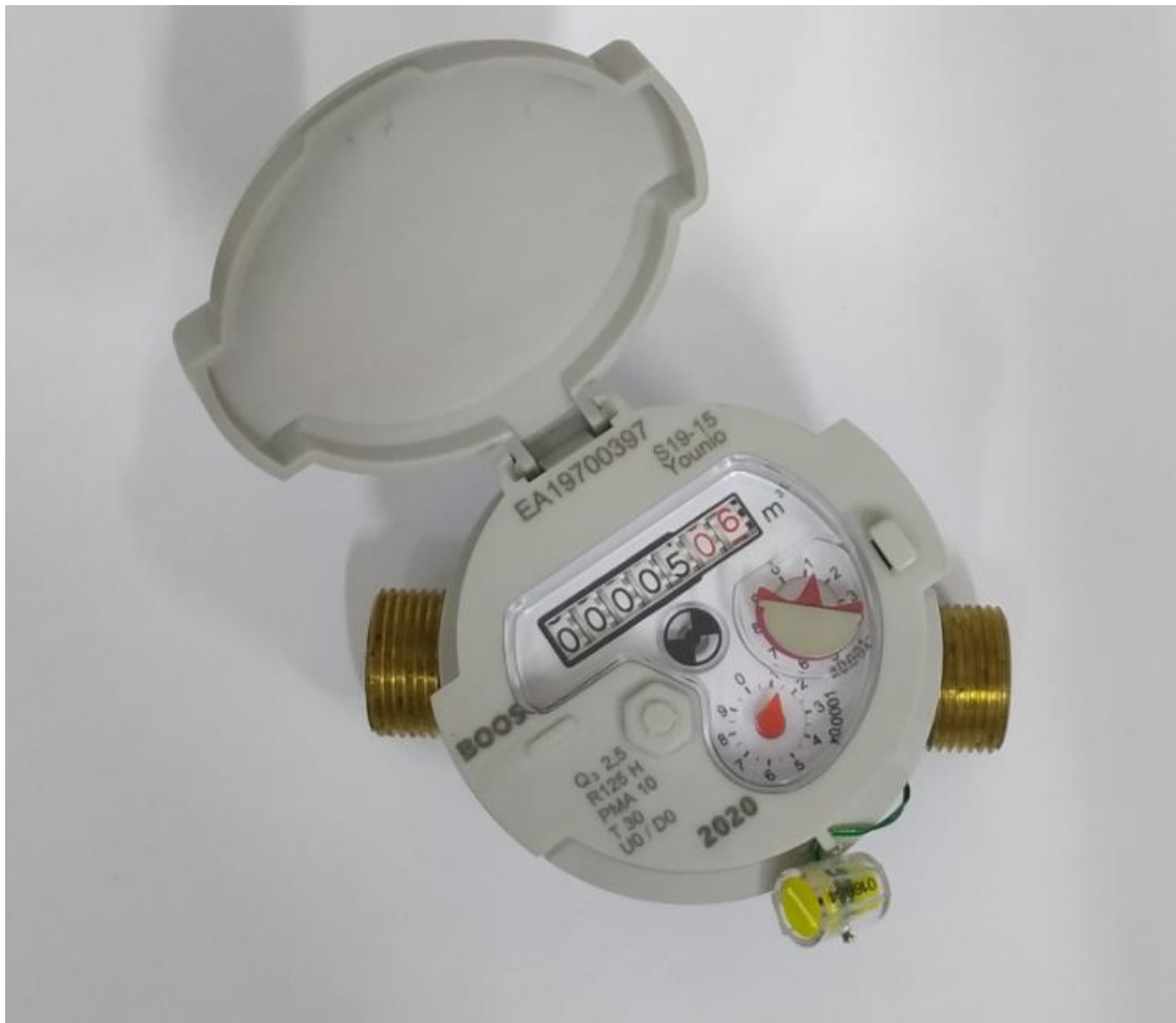
Fotografía 1. Vista superior de la muestra entera del medidor de agua, marca BOOS, modelo S19
