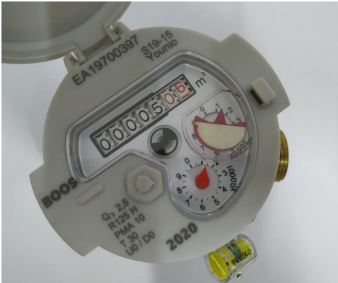
Fotografía 2. Vista superior del dispositivo indicador de la muestra entera del medidor de agua, marca BOOS, modelo S19
