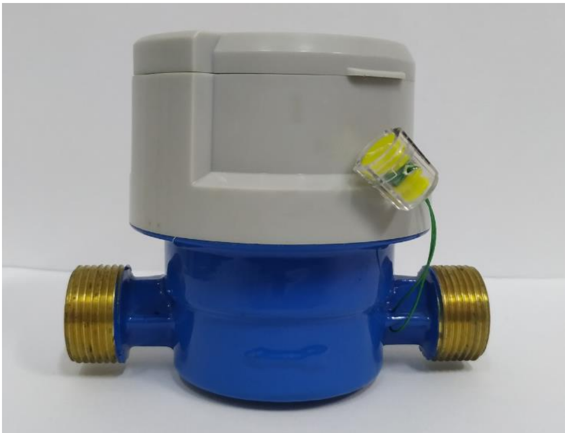
Fotografía 3. Vista lateral de la muestra entera del medidor de agua, marca BOOS, modelo S19
